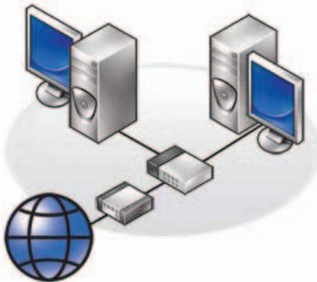
Ein LAN verbindet zwei oder mehrere Computer über ein Netzwerkkabel, das an jedem Computer angeschlossen ist. Diese Art Computernetzwerk ist normalerweise für einen kleinen Bereich gedacht. Ein LAN kann mit einem anderen (auch weit entfernten) LAN über Telefonleitungen oder Funk verbunden werden. Das resultierende Netzwerk wird als WAN (Wide Area Network, Weitbereichsnetzwerk) bezeichnet.
