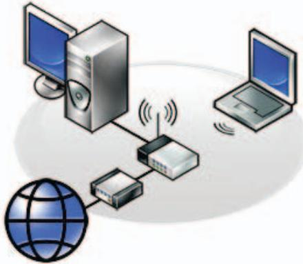
Ein WLAN stellt eine Verbindung her zwischen zwei oder mehreren Computern miteinander und dem Internet über Funk, ohne dass die Computer über Netzwerkkabel angeschlossen sind.
