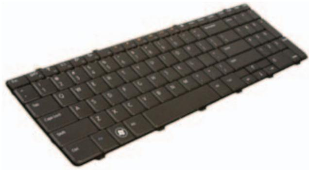
Die meisten Tastaturen besitzen zusätzliche zu den normalen Zahlentasten ein numerisches Tastenfeld mit einer Standardanordnung von numerischen und mathematischen Funktionstasten. Bei Laptops ist eine physische Tastatur standardmäßig in das Gehäuse integriert, aus Platzgründen wird jedoch meist auf das numerische Tastenfeld verzichtet. Kleine Laptops und Netbook-Computer haben u. U. keine physische Tastatur, sondern verfügen über eine Bildschirmtastatur.
